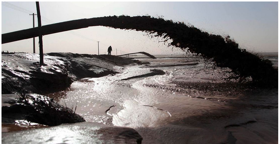
In der chinesischen Stadt Baotou erfolgt die Weiterverarbeitung von Erzen. Die dabei entstehenden Abwässer bilden einen Schlacken-See, der zu den giftigsten Orten der Welt zählt. 17 © picture alliance/dpa/Chinafotopress/Weng Huan
